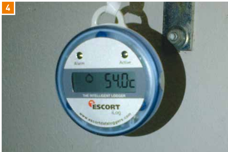
Data logger per la registrazione delle temperature.
