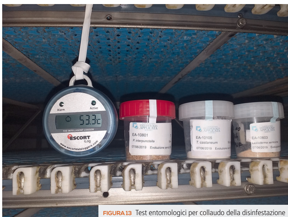
FIGURA 12 Rilievo delle temperature durante il trattamento con termo-camera
