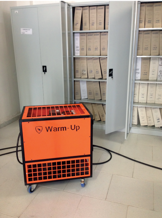
2. Termoconvettore TVE 10 KW posizionato nel locale con armadi e faldoni
